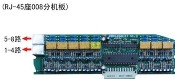
每块 8 路分机板提供 8 个内部分机接口; 如采用 2 个 RJ-45 接口, 每个接口可以配接 4 路内部分机, 接口图如下:
