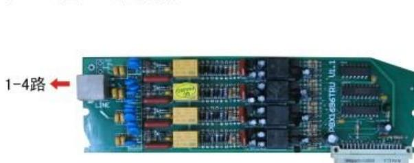
每块 4 路外线板提供 4 个双向外线接口; 如采用 RJ-45 接口, 接口图如下:
