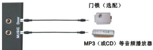
注意：当外置音乐连接线插入接口后，系统自动切换到外置音乐。如果使用内部音乐时，请记住将外置音乐连接线取开，否则就无音乐。
